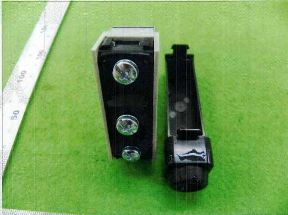
〈제 2특성수 시험 결과(물 침입 확인)〉
