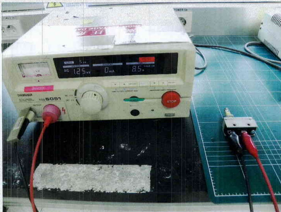
〈제 2특성수 시험 결과(내전압 시험)〉
